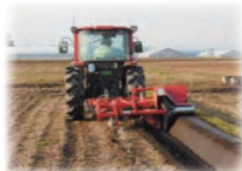
畦畔の畔塗、再構築
